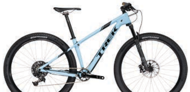
PROCALIBER 9.7 WOMEN'S Powder Blue RAHMEN OCLV Mountain Carbon FEDERUNG Fox Performance 32 Float SC, 100 mm Federweg SCHALTWERK SRAM X1, Roller Bearing Clutch KURBELGARNITUR SRAM X11200 LAUFRÄDER Bontrager Mustang Pro, Tubeless Ready, Boost110 vorne, Boost148 hinten (15,5": 142 x 12 mm hinten)
