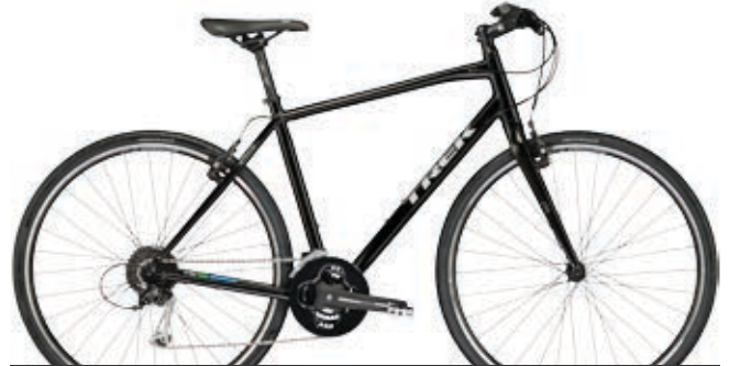
FX 3 Trek Black RAHMEN FX Alpha Gold Aluminium GABEL Bontrager Nebula aus Carbon SCHALTWERK Shimano Alivio T4000 KURBELGARNITUR FSA Dyna Drive LAUFRÄDER Aluminium-Naben von Formula; Felgen Bontrager Tubeless Ready
