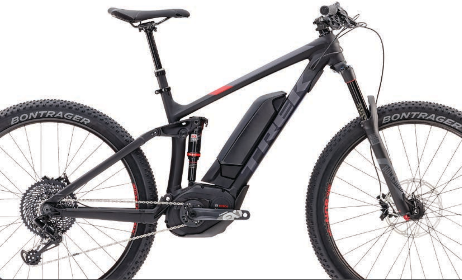
POWERFLY 9 FS PLUS Matte Trek Black/Viper Red RAHMEN Alpha Platinum Aluminium, 130 mm hinterer Federweg FEDERUNG RockShox Pike RC, 130 mm Federweg; RockShox Deluxe RT3, RE:aktiv SCHALTWERK SRAM EX1, Roller Bearing Clutch KURBELGARNITUR SRAM EX1 LAUFRÄDER Naben von Bontrager, gedichtete Lager, Boost110 vorne, Boost148 hinten; Felgen SUNringlé Duroc 40 SL
