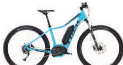
POWERFLY 5 WOMEN'S Matte California Skye Blue RAHMEN WSD Alpha Platinum Aluminium FEDERUNG RockShox Recon Silver, 100 mm Federweg SCHALTWERK Shimano Alivio M430 KURBELGARNITUR RIDE+ Aluminium LAUFRÄDER Vorderradnabe Shimano TX-505; Hinterradnabe Shimano M3050; Felgen Bontrager XR850
