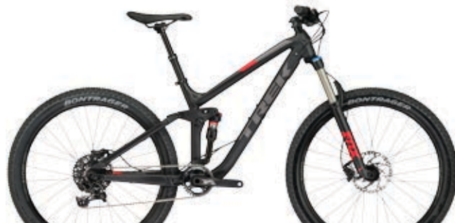
FUEL EX 8 27.5 PLUS Matte Trek Black RAHMEN Alpha Platinum Aluminium, 130 mm hinterer Federweg FEDERUNG Fox Performance 34 Float, 140 mm Federweg; Fox Performance Float EVOL, RE:aktiv SCHALTWERK SRAM GX, Roller Bearing Clutch KURBELGARNITUR SRAM GX 1000 LAUFRÄDER Naben von Bontrager, Boost110 vorne, Boost148 hinten; Felgen SUNRinglé Duroc 40 SL
