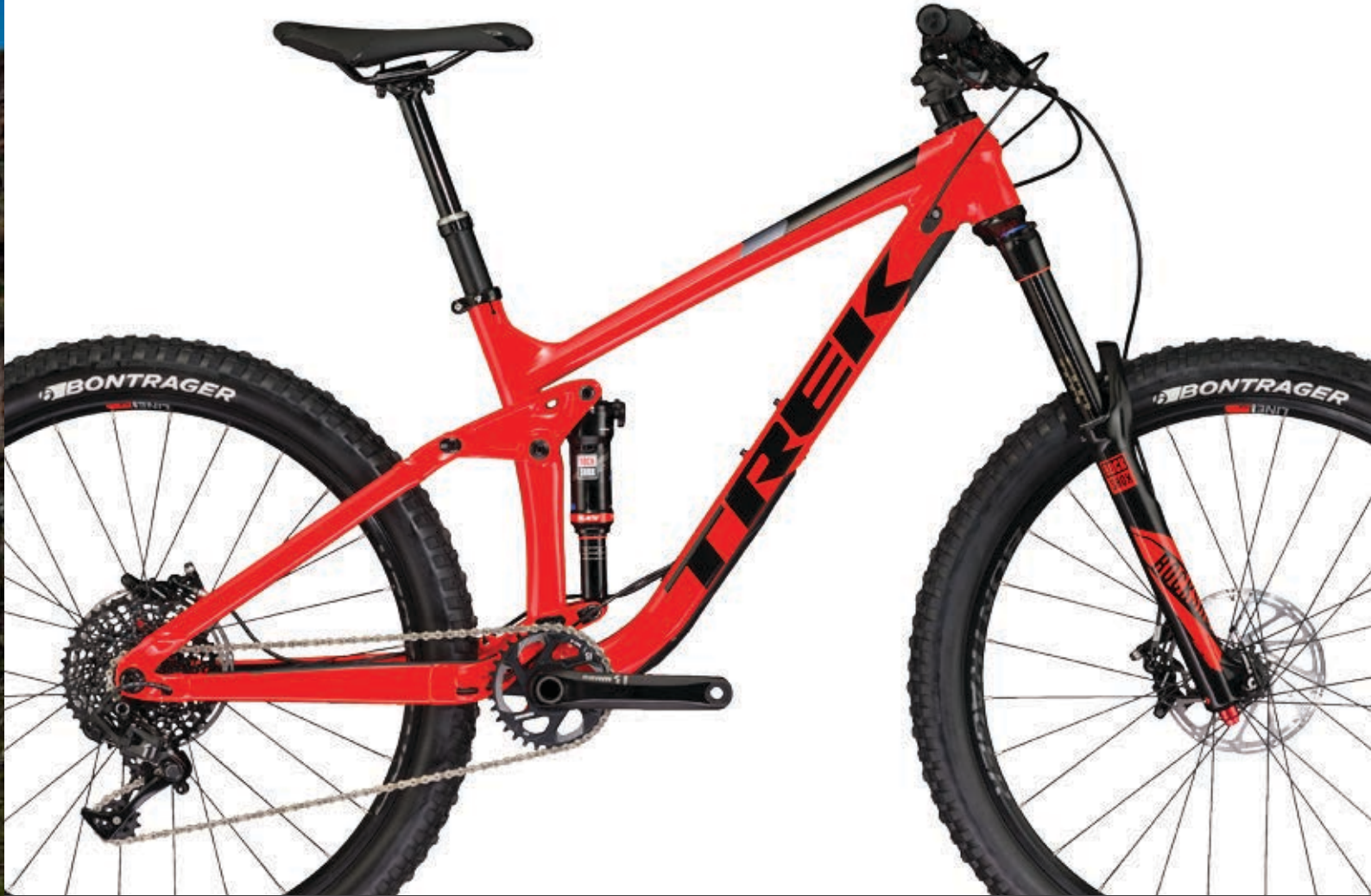
REMEDY 9 RACE SHOP LIMITED Viper Red/Trek Black RAHMEN Alpha Platinum Aluminium, 150 mm hinterer Federweg; FEDERUNG RockShox Lyrik RC, 130/160 mm Federweg; RockShox Deluxe RT3, RE:aktiv SCHALTWERK SRAM X1, Roller Bearing Clutch KURBELGARNITUR SRAM X1 1200 LAUFRÄDER Bontrager Line Comp 30, Tubeless Ready, Boost110 vorne, Boost148 hinten
