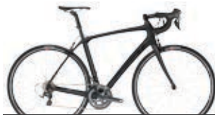
DOMANE SLR 6 Matte/Gloss Trek Black RAHMEN 600 Series OCLV Carbon, Front and Adjustable Rear IsoSpeed GABEL Domane aus Vollcarbon SCHALTWERK Shimano Ultegra KURBELGARNITUR Shimano Ultegra LAUFRÄDER Bontrager Paradigm Comp Tubeless Ready
