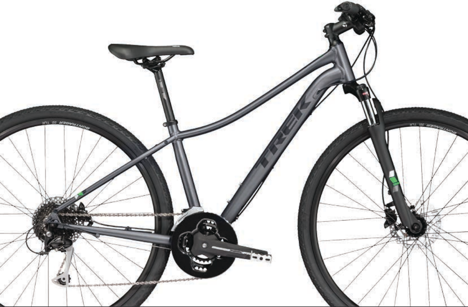
NEKO 3 WOMEN'S Matte Metallic Charcoal RAHMEN WSD Alpha Gold Aluminium SCHALTWERK Shimano Alivio T4000 KURBELGARNITUR FSA Dyna Drive LAUFRÄDER Aluminium-Naben von Formula; Felgen Bontrager Tubeless Ready
