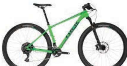
SUPERFLY 6 Matte Green-light RAHMEN Alpha Platinum Aluminium FEDERUNG RockShox Reba RL, 100 mm Federweg SCHALTWERK SRAM GX, Roller Bearing Clutch KURBELGARNITUR SRAM GX 1000 LAUFRÄDER Naben von Bontrager, gedichtete Lager, 15 mm vorne; Felgen Bontrager Mustang Elite Tubeless Ready
