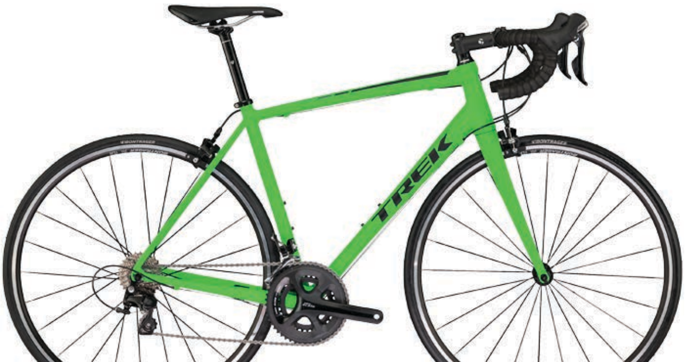
ÉMONDA ALR 5 Matte Green-light RAHMEN Ultraleichtes 300 Series Alpha Aluminium GABEL Émonda aus Vollcarbon SCHALTWERK Shimano 105 KURBELGARNITUR Shimano 105 LAUFRÄDER Aluminium-Naben; Felgen Bontrager Tubeless Ready
