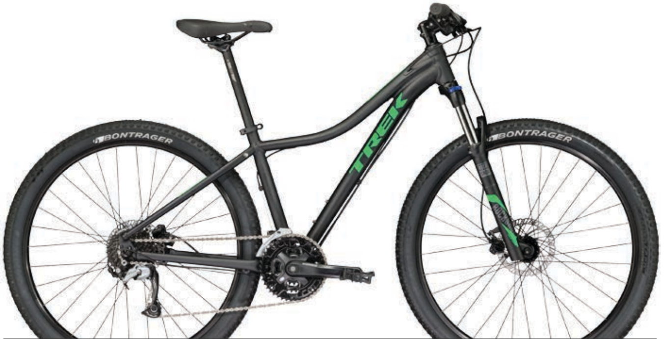
CALI S WOMEN'S Matte Black Pearl RAHMEN WSD Alpha Gold Aluminium FEDERUNG RockShox 30, 100 mm Federweg (13,5: 80 mm Federweg) SCHALTWERK Shimano Acera M3000, Shadow KURBELGARNITUR Shimano M351 LAUFRÄDER Aluminium-Naben von Formula, Felgen Bontrager Connection
