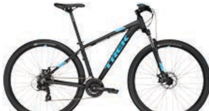
MARLIN 5 Matte Trek Black RAHMEN Alpha Silver Aluminium FEDERUNG SR Suntour XCT, 100 mm Federweg (13,5; 80 mm Federweg) SCHALTWERK Shimano Tourney TY300 KURBELGARNITUR Shimano Tourney TY501 LAUFRÄDER Formula DC27-Hinterradnabe aus Aluminium; Bontrager Connection-Hohlkammerfelgen (32 Loch)
