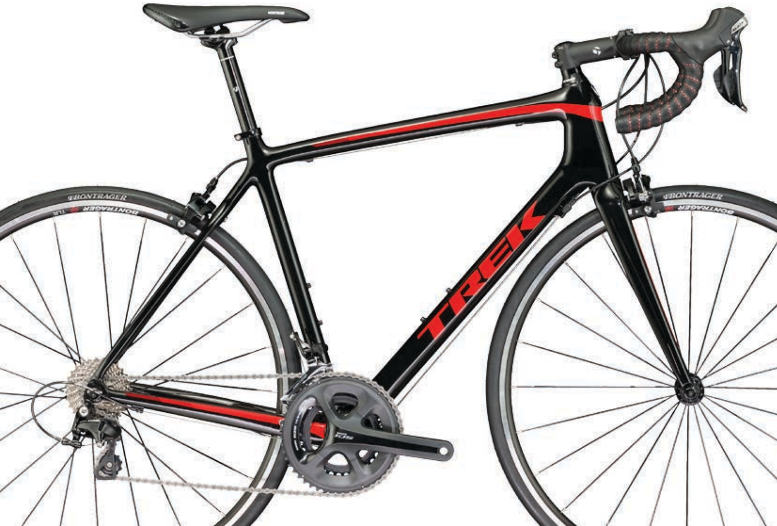
ÉMONDA S 5 Trek Black/Viper Red RAHMEN Ultraleichtes 300 Series OCLV Carbon FORK Émonda aus Carbon SCHALTWERK Shimano 105 KURBELGARNITUR Shimano 105 LAUFRÄDER Aluminium-Naben; Felgen Bontrager Tubeless Ready
