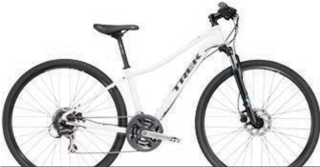
NEKO 2 WOMEN'S Crystal White RAHMEN WSD Alpha Gold Aluminium SCHALTWERK Shimano Acera M360 KURBELGARNITUR Geschmiedetes Aluminium LAUFRÄDER Aluminium-Naben von Formula; Aluminium-Felgen Bontrager AT-750
