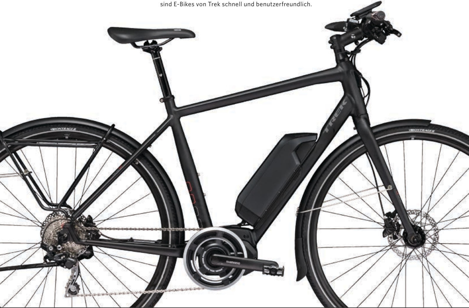
CONDUIT+ Matte Trek Black RAHMEN Alpha Gold Aluminium GABEL FX Disc aus Aluminium SCHALTWERK Shimano Deore Shadow Plus KURBELGARNITUR SHIMANO STEPS LAUFRÄDER Aluminium-Naben von Formula; Felgen Bontrager Tubeless Ready
