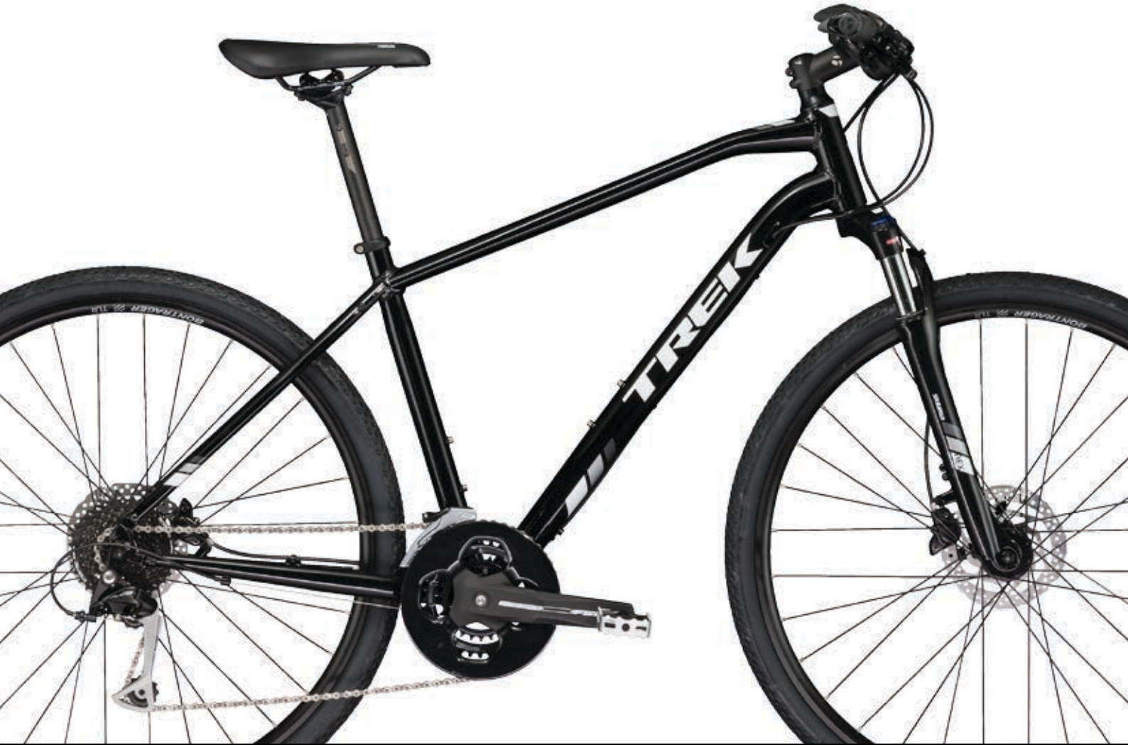
DS 3 Trek Black RAHMEN Alpha Gold Aluminium SCHALTWERK Shimano Alivio T4000 KURBELGARNITUR FSA Dyna Drive LAUFRÄDER Aluminium-Naben von Formula; Felgen Bontrager Tubeless Ready
