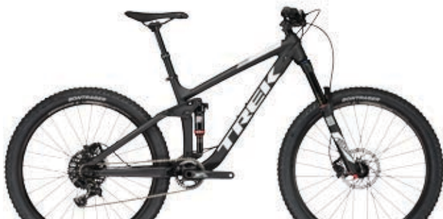
REMEDY 8 Matte Trek Black/Gloss Trek White RAHMEN Alpha Platinum Aluminium, 150 mm hinterer Federweg; FEDERUNG RockShox Pike RC, 150 mm Federweg; RockShox Deluxe RT3, RE:aktiv SCHALTWERK SRAM GX, Roller Bearing Clutch KURBELGARNITUR SRAM GX 1000 LAUFRÄDER Bontrager Duster Elite, Tubeless Ready, Boost110 vorne, Boost148 hinten
