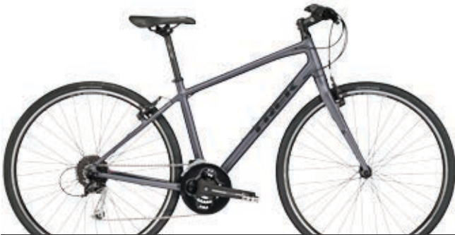
FX 3 WOMEN'S Matte Metallic Charcoal RAHMEN WSD FX Alpha Gold Aluminium GABEL Bontrager Nebula aus Carbon SCHALTWERK Shimano Alivio T4000 KURBELGARNITUR FSA Dyna Drive LAUFRÄDER Aluminium-Naben von Formula; Felgen Bontrager Tubeless Ready
