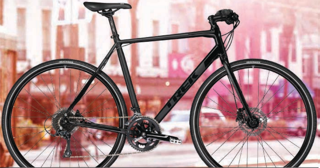
ZEKTOR 3 Gloss/Matte Trek Black RAHMEN Alpha Silver Aluminium GABEL CrMo-Gabelschaft, Aluminium-Gabelscheiden SCHALTWERK Shimano Sora KURBELGARNITUR FSA Vero Pro LAUFRÄDER Aluminium-Naben von Formula; Felgen Bontrager Tubeless Ready
