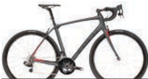
DOMANE SLR 9 ETAP Matte Dnister Black/Viper Red RAHMEN 600 Series OCLV Carbon, Front and Adjustable Rear IsoSpeed GABEL Domane aus Vollcarbon SCHALTWERK SRAM RED eTap KURBELGARNITUR SRAM RED LAUFRÄDER Bontrager Aeolus 3 Tubeless Ready D3
