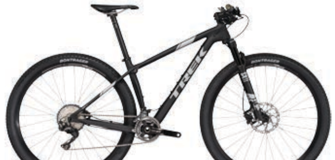
PROCALIBER 9.7 Matte Trek Black RAHMEN OCLV Mountain Carbon FEDERUNG Fox Performance 32 Float SC, 100 mm Federweg SCHALTWERK Shimano Deore XT Shadow Plus KURBELGARNITUR Shimano Deore XT LAUFRÄDER Bontrager Mustang Pro, Tubeless Ready, Boost110 vorne, Boost148 hinten (15,5": 142 x 12 mm hinten)
