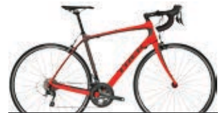
DOMANE S 4 Matte Viper Red/Dark Roast Black RAHMEN 400 Series OCLV Carbon, IsoSpeed GABEL Domane aus Carbon SCHALTWERK Shimano Tiagra KURBELGARNITUR Shimano Tiagra LAUFRÄDER Aluminium-Naben; Felgen Bontrager Tubeless Ready
